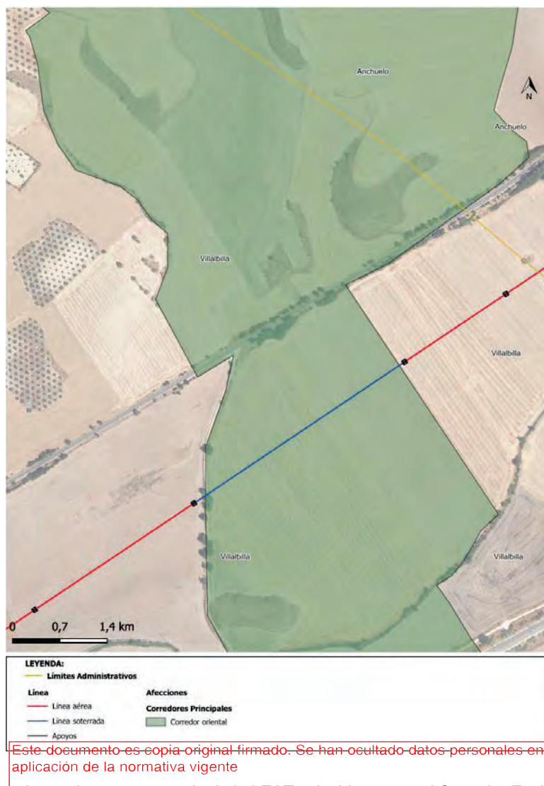
Figura 9. En color azul tramo soterrado de la LEAT coincidente con el Corredor Ecológico Oriental.
